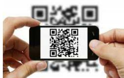
Grazie al codice QR code integrato, la configurazione dell'applicazione per mobile Android e iOS avviene in modo automatico inquadrando il codice del DVR visualizzato sul monitor. L'operazione trasferisce all'applicazione la password unica del DVR permettendo l'accesso remoto e sicuro attraverso il servizio P2P.
